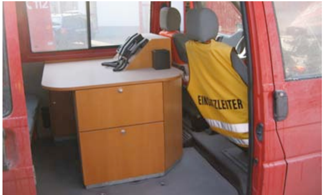
Der Funktisch, der den Brand überlebt hatte, konnte aus dem Altfahrzeug ausgebaut werden.
